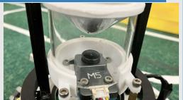
カメラをOpenMVからUnitViに切り替えたことで、システムのコード拡張性が向上した。調整されたファームウェアによって、**処理スピードが改善された**。新しいカメラシステムの導入により、オフENS機体はゴールを狙いやすくなり、ディフェンス機体はポジションを維持しやすくなるなど、**コントロールの質が向上した**。
