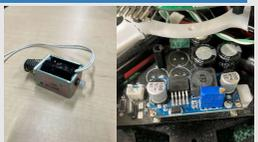
得点能力を向上させるために追加した。ソレノイドに電力を供給する昇圧回路のコンデンサーに接続されている抵抗をセメント抵抗に変更することで、熱抵抗を強化し、**より効率的な速射を可能にした**。ボイのデザイン面では、ソレノイドを最も効果的な位置に配置することで、**ゴールに向かうシュートスピードが向上した**。
