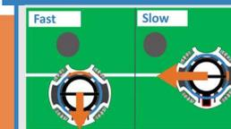
攻守のラインセンサープログラムを統合し、**デバッグ作業を効率化しました**。さらに、マシンのスピードが速いときは、最初に記録したラインとは逆方向に動くので、たとえラインを越えても確実にラインを越えない。マシンの速度が遅いときは、守備ライン処理のテクニクを応用して、**通常ならラインをギリギリ越えて届かないボールを追いかけけることができる**。
