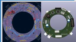
すべての配線をメイン基板に集約することで、**機体をコンパクトにし、メンテナンス性を向上させました**。この基板には、高速処理が可能STM32F446REをメインCPUとして採用しています。さらに、センサーの読み取りを他のマイコンに任せすることで、メインCPUは処理に集中でき、**高速データ処理を実現しています**。
