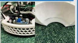
ボディの軽量化を追求するため、壁面にはハニカム構造を採用し、トッププレートも必要最小限に設計。さらに、ホルド部に角度をつけることで、従来の課題であったホルド部からのボールの飛び出しも解消。この改善により、**確実なボール保持が可能となり、ゴールへのシュート成功率が向上した**。
