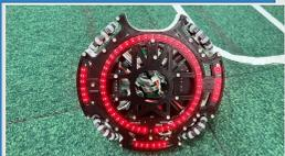
ラインセンサーを大きな円形に配置することで、**白線を広範囲に正確に検出することが可能**。また、円の外側にサブセンサーとして設置することで、**白線の検出速度を向上させている**。さらに、ボールセンサーと同様にサブCPUにSTM32F446REを採用することで、**高速データ処理を実現している**。
